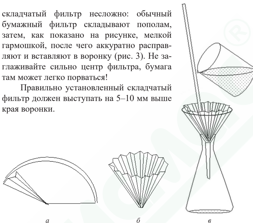
Рисунок 3. Приготовление складчатого фильтра и фильтрование: а — изготовление складчатого фильтра, б — готовый складчатый фильтр, в — установка для фильтрования,.
